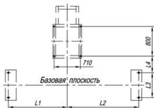
Расположение отверстий под фундаментные болты М30
