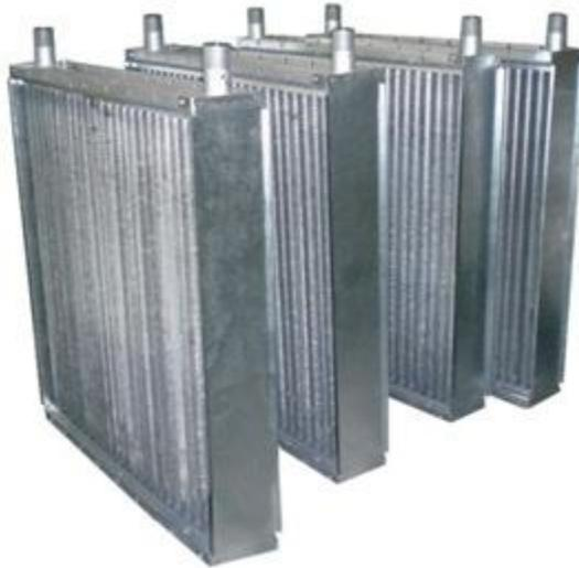
Системы утилизации или регенерации теплоты с промежуточным теплоносителем состоят из теплообменников, расположенных в каналах удаляемого и приточного воздуха, соединенных замкнутым циркуляционным контуром. Циркуляция теплоносителя осуществляется при помощи насосов. В теплообменниках удаляемый воздух передает свое тепло промежуточному теплоносителю, нагревающему приточный воздух.
