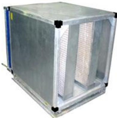
В блоке шумоглушения установлен пластинчатый шумоглушитель, предназначенный для снижения уровня звуковой мощности, создаваемой вентилятором центрального кондиционера. Устанавливается обычно после блока вентилятора, между ними обязательно размещают промежуточный блок для распределения потока воздуха после выходного отверстия вентилятора, особенно для вентиляторов с лопатками, загнутыми вперед.
