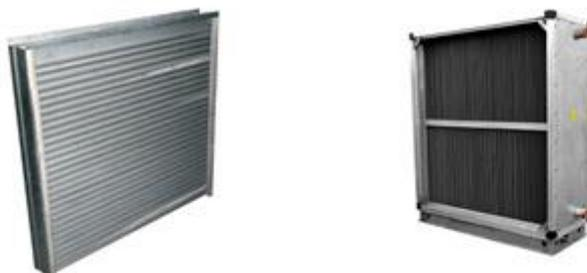
Этот блок предназначен для охлаждения или осушения воздуха. Для этих целей используются медные или стальные воздухоохладители. В качестве охладителя выступает этиленгликолевая смесь или холодная вода. При охлаждении и осушении воздуха выделяется влага, поэтому блок воздухоохладителя оснащен каплеуловителем и поддоном для сбора воды.
