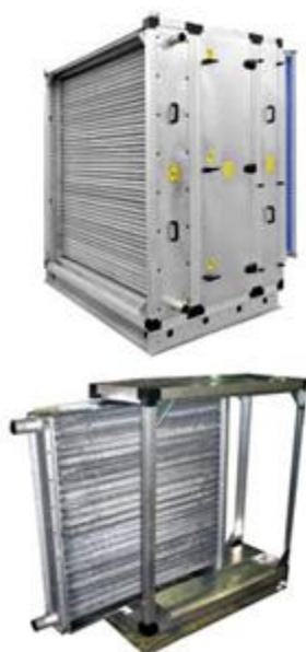
Воздуонагревательный блок отвечает за нагрев воздуха. В качестве теплоносителей используется вода или пар. Между воздухом и теплоносителем имеется разделительная стенка. Нагревательный элемент представляет собой металлическую трубу с оребрением. Материалом изготовления трубы может служить медь и алюминиевые пластины или сталь и алюминиевое оребрение.
