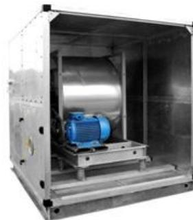
Этот блок отвечает за перемещение воздушных потоков в кондиционере. Здесь используются радиальные вентиляторы с клиноременной передачей и двухсторонним всасыванием. Рабочее колесо вентилятора имеет загнутые вперед или назад лопатки. В качестве электроприводов используются трехфазные электродвигатели. Выхлопной патрубок вентилятора оснащен гибкой вставкой, снижающей уровень вибрации вентилятора.
