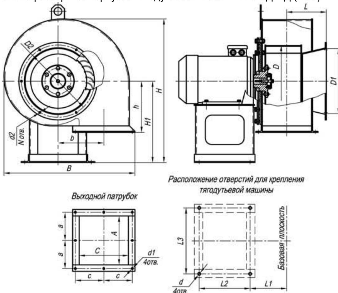
Расположение отверстий для крепления тягодутьевой машины
