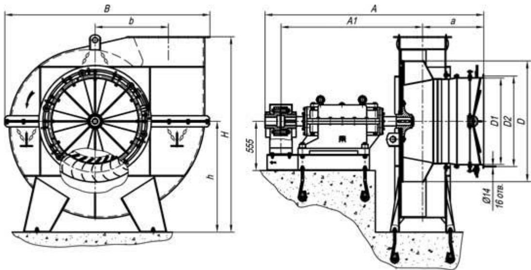
Расположение отверстий под фундаментные болты М24
