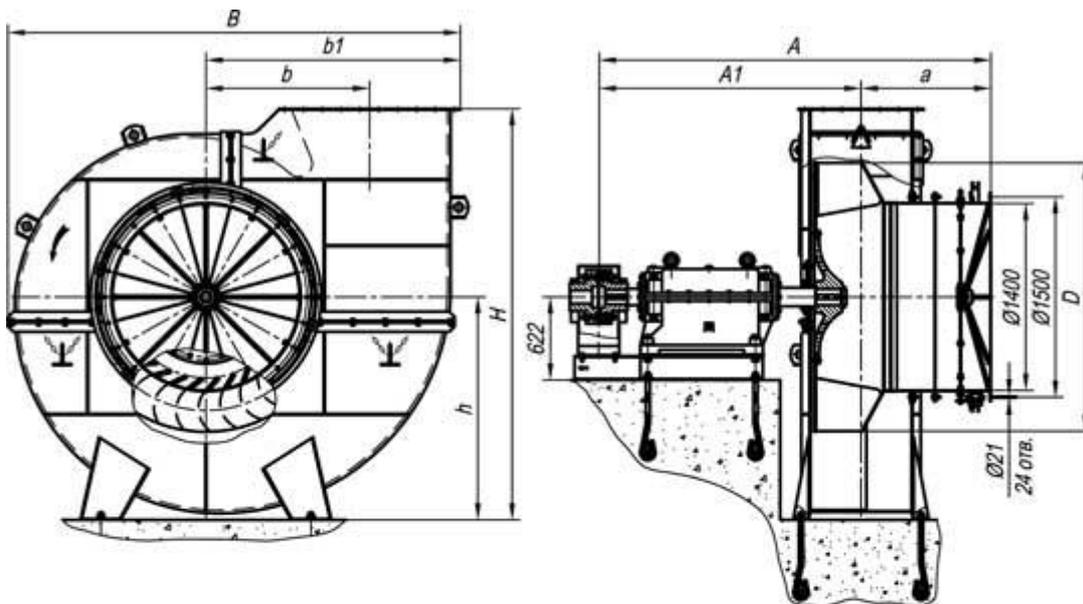
Расположение отверстий под фундаментные болты М30
