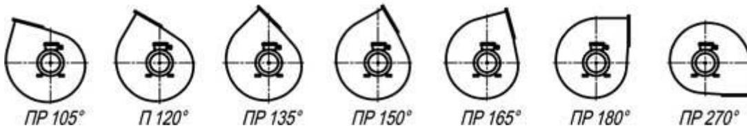
Схема разворотов корпусов тягодутьевых машин типа ВД и Д (ЛЕВ).
